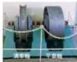
ケーブルの車輪の展示 ケーブルカーの車輪は満車輪・平車輪の二種類があります。満車輪によって車両の進む方向が決まります。
